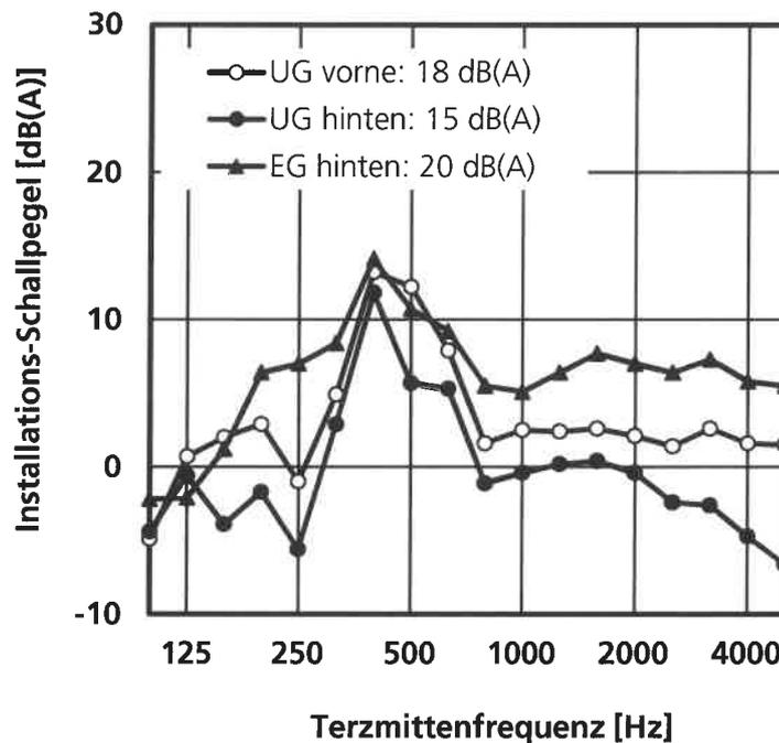
Frequenzverlauf des Installations-Schallpegels bei Geräuschanregung mit dem Körperschall-Geräuschnormal (KGN), gemessen in den Räumen UG vorne, UG hinten und EG hinten. In der Legende sind die Installations-Schallpegel  $L_{A\text{Freq},n}$  ( $L_{In}$ ) in dB(A) nach DIN 4109 für den abgebildeten Frequenzbereich von 100 bis 5000 Hz angegeben.
